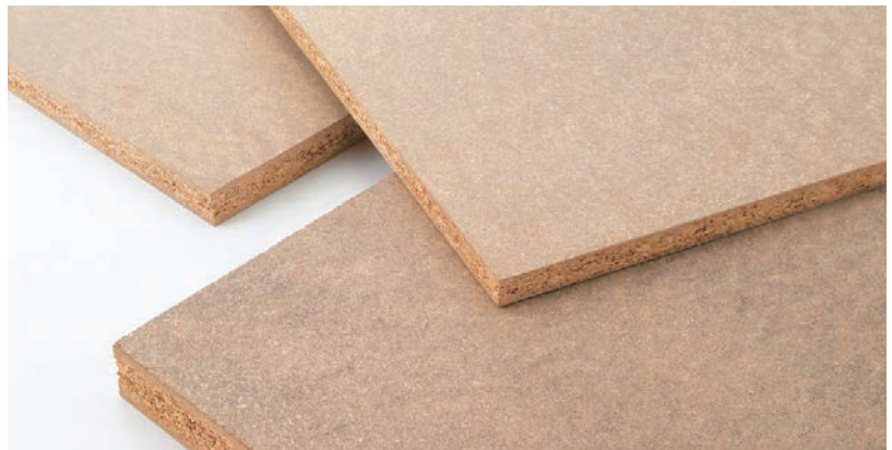
パーティクルボードには、耐力面材、フロア基材のほか、新規用途開発の期待がかかる
