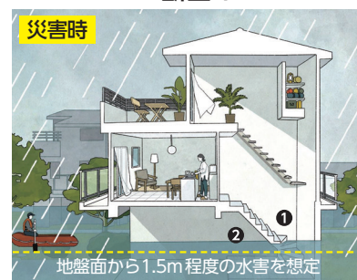
1階をRC造とすることで、万が一浸水した場合でも、木造と比較して現状復旧が早い
